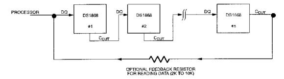
The  $C_{OUT}$  output of the DS1868 can be used to drive the DQ input of another DS1868. When connecting multiple devices, the total number of bits transmitted is always 17 times the number of DS1868s in the daisy chain.
