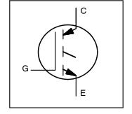
600V  $I_{C(nom)}=4.0A$   $V_{CE(on)}$  typ. = 1.75V @4.0A
